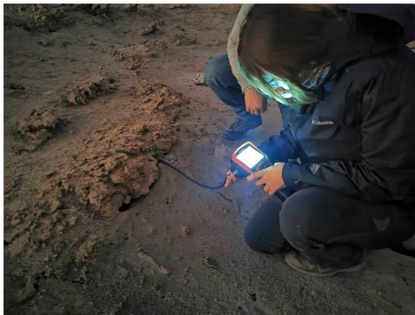
FIGURA 5. PROSPECCIÓN CON CÁMARA SONDA MARCA RIDGID CA-350 FUENTE: ELABORACIÓN PROPIA.
