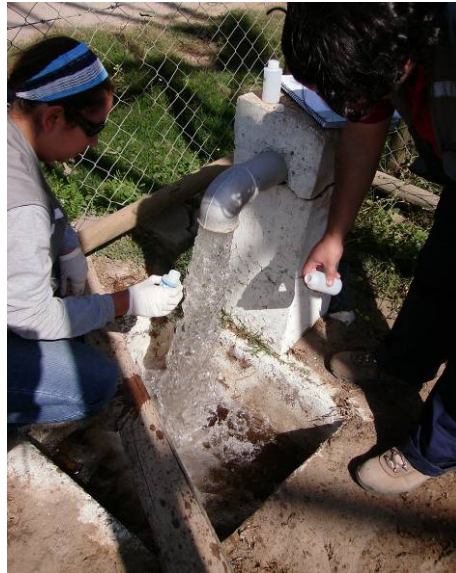
Muestreo de aguas subterráneas en pozo con bomba instalada
