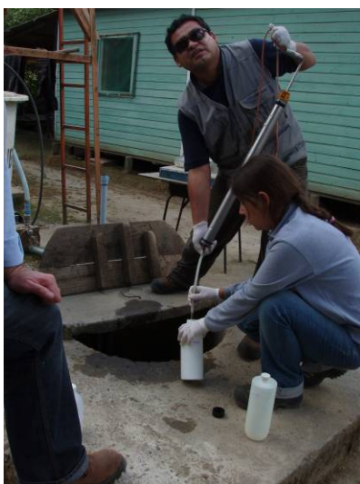
Muestreo de aguas subterráneas (noria), con botella muestreadora vertical de doble tapa
