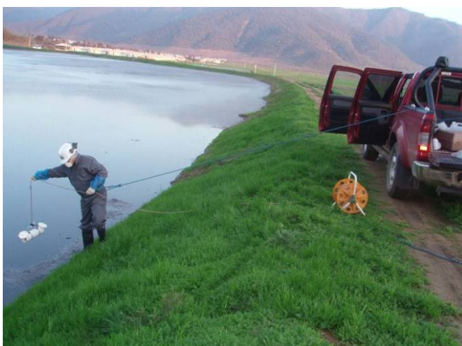
Muestreo de purines almacenados en lagunas, con botella muestreadora horizontal de doble tapa
