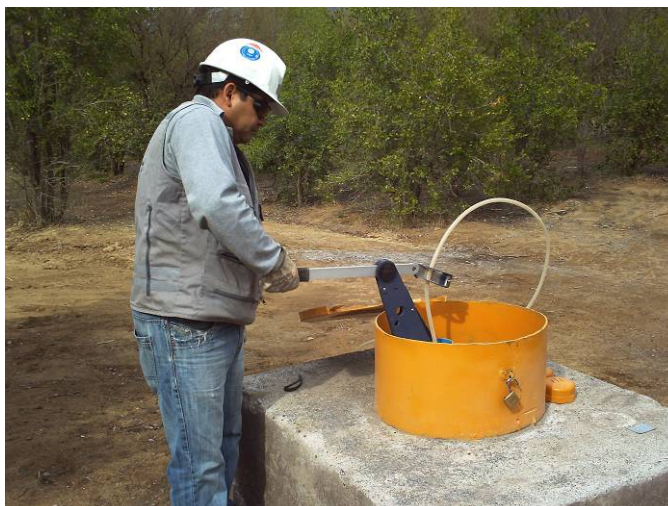
Muestreo de aguas subterráneas (pozo) con bomba manual tipo Watterra
